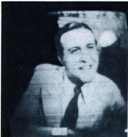
O b e n : Das etwa leistet das heutige Fernsehen mit 180 Zellen ohne Zellen sprungverfahren. Der unmittelbare Eindruck ist besser als dieses Bild.
